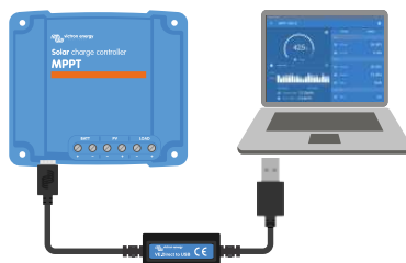
De VictronConnect-app verbinding via USB door gebruik te maken van een VE.Direct USB-interface
