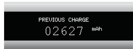
Die Anzeige „Previous Charge“ zeigt die jeweils zuletzt geladene Kapazität. Es ist durchaus üblich, dass Benutzer ihr InLine® USB Smart Control Multimeter angeschlossen lassen, nachdem Smartphone oder Tablet vollständig geladen wurde. Bedenken Sie, dass diese Geräte weiterhin Energie ziehen, wenn sie erkennen, dass die Batteriekapazität erneut abnimmt, um bspw. mit WLAN, Bluetooth oder dem Mobilfunknetz verbunden zu bleiben.
