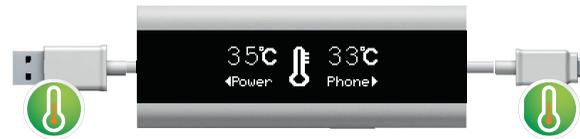
Das InLine® USB Smart Control Multimeter verfügt über Temperatursensoren an beiden Enden des Kabels und prüft damit Ihre Stromquelle und Ihr mobiles Gerät, wie mit einer Angabe der gemessenen Temperatur auf dem Display angezeigt. Das Laden wird abgebrochen, sobald erhöhte Temperaturen erkannt werden (ab 55°C beim Laden mit weniger als 7,5W / ab 65°C beim Laden mit mehr als 7,5W).
