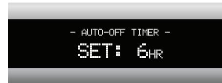
Der Ladezeit-Timer dient dazu, eine bestimmte Ladezeit (2, 4, 6, 8, 10 Stunden) vorzugeben, nach der das InLine® USB Smart Control Multimeter den Ladevorgang automatisch stoppt. Um den Ladezeit-Timer einzustellen, halten Sie die Taste gedrückt, bis die entsprechende Anzeige erfolgt. Lassen Sie die Taste kurz los und halten Sie sie anschließend erneut gedrückt.
