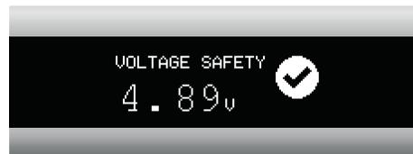
Der Mikroprozessor des InLine® USB Smart Control Multimeters überwacht die Spannung vom Stromgeber zum Empfangsgerät auf Anzeichen von Ausfällen oder Überlastungen. Dies ist besonders kritisch, wenn USB-Netzteile von Drittanbietern verwendet werden. Das InLine® USB Smart Control Multimeter stoppt den Ladevorgang, falls Stromspannungen (< 4,5V) auftreten.
