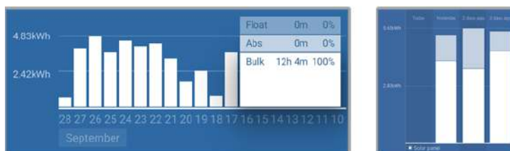
Systeem brengt al zijn tijd in bulk door met uitsplitsing van laadfasen - Systeem in bulk en absorptie
