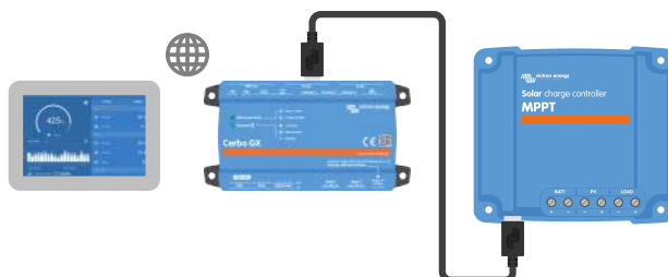
VictronConnect-app verbinding via LAN of het internet (VRM-portaal) door gebruik te maken van een GX-apparaat (bijvoorbeeld een Cerbo GX)
