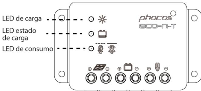
El controlador dispone de 3 LEDs para visualizar el estado de funcionamiento.
